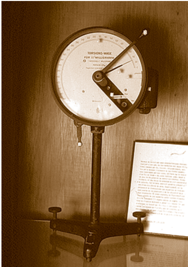
La primera Balanza apoyada en un equilibrio de pesas, fue ampliamente superada por el sistema de torsión, mucho más preciso
