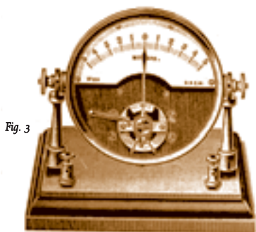
Fig. 3: Galvanómetro aperiódico con pie y listo para funcionar en todas las posiciones
