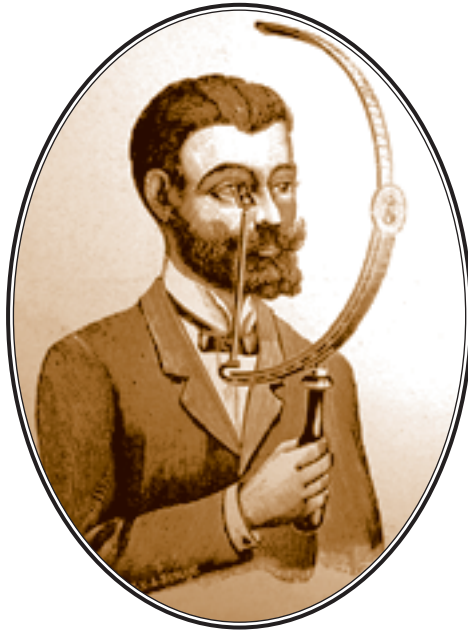
Perímetro de mano propuesto por Schweigger, con juego de discos blancos y de colores ajustables a un mango
